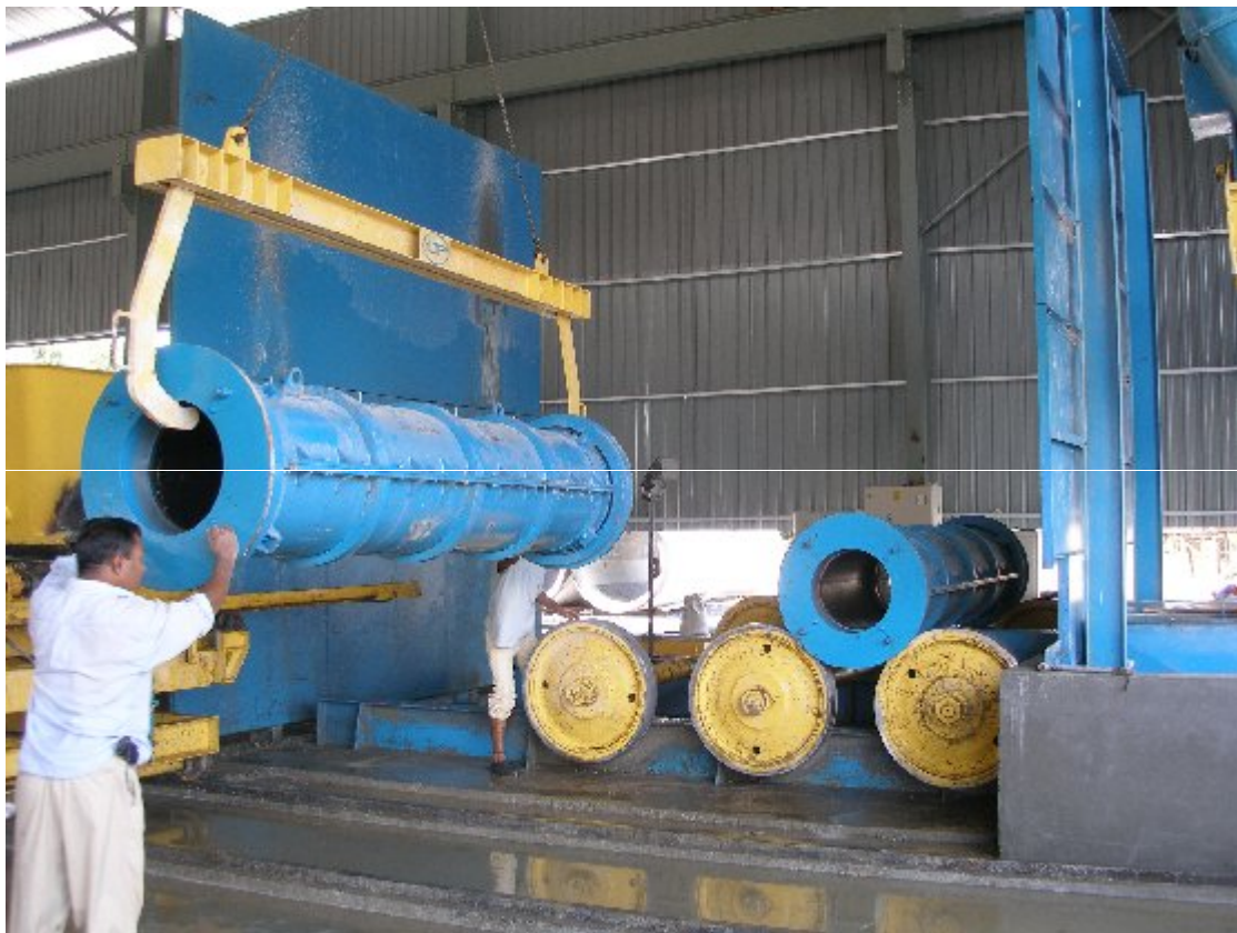
Spun Pipe Machine
